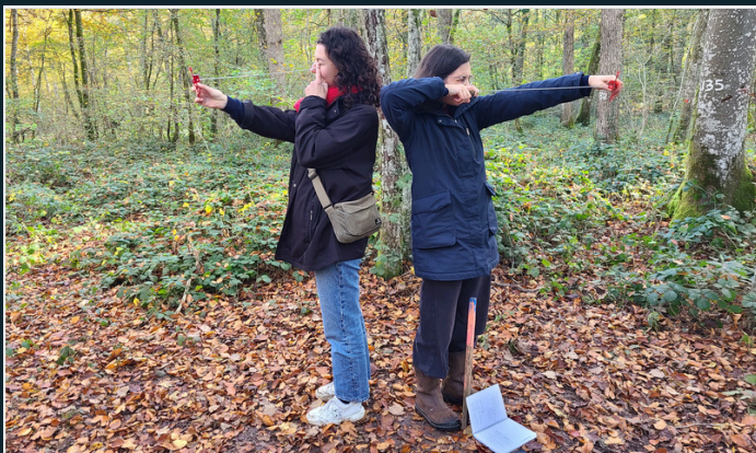
Entraînement sur le terrieroscope à la mesure de la surface terrière, indicateur facile à prendre sur le terrain et qui donne une idée rapide du capital (quantité de bois en forêt).
